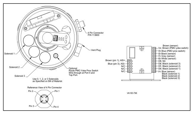
Figure 14 - AS-i Eurofast Wiring
